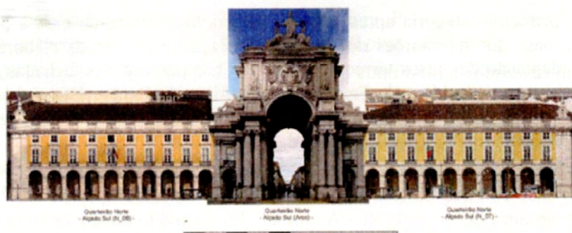
Figura 1: Alçado métrico rectificado do alçado sul do Terreiro do Paço obtido através da rectificação de panoramas.
