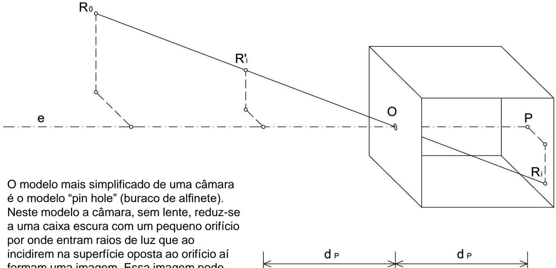
O modelo mais simplificado de uma câmara é o modelo “pin hole” (buraco de alfinete). Neste modelo a câmara, sem lente, reduz-se a uma caixa escura com um pequeno orifício por onde entram raios de luz que ao incidirem na superfície oposta ao orifício aí formam uma imagem. Essa imagem pode ser capturada se na superfície for colocado um material sensível à luz.
