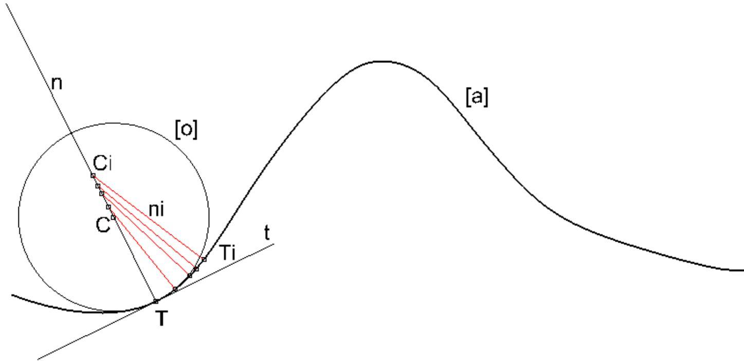
Na figura, às rectas  $t$  e  $n$  pode ser associado uma sistema de coordenadas rectangular, de origem em  $T$  que, como a curva é plana, está contido no plano da mesma. O terceiro eixo deste sistema de coordenadas, é uma recta passante pelo ponto  $T$  que é simultaneamente perpendicular às rectas  $t$  e  $n$ , e que se designa por recta BI-NORMAL à curva em  $T$ .
