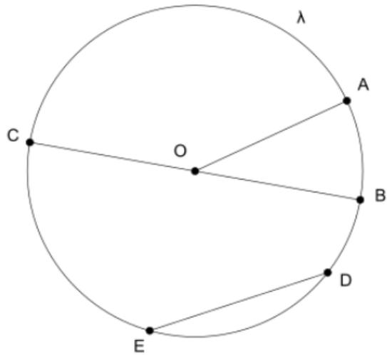
Exemplos de corda, diâmetro e raio de uma circunferência: Raio  $\overline{AO}$ , Diâmetro  $\overline{BC}$  e Corda  $\overline{ED}$ .
