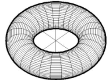
GERAÇÃO DO TORO POR ROTAÇÃO DE UMA CIRCUNFERÊNCIA EM TORNO DE UM EIXO COMPLANAR
