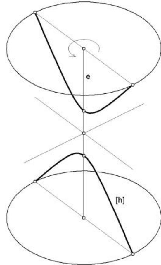
GERAÇÃO DO HIP. DE REVOLUÇÃO DE 2 FOLHAS POR ROTAÇÃO DA HIPÉRBOLE EM TORNO DO SEU EIXO
