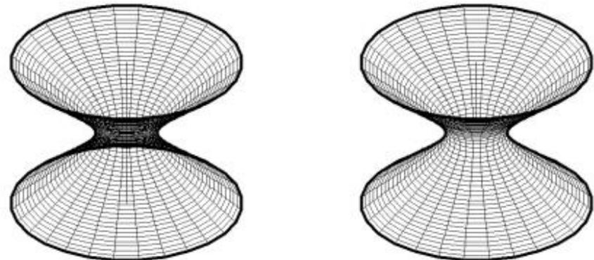
GERAÇÃO DO HIP. DE REVOLUÇÃO REGRADO POR ROTAÇÃO DA HIPÉRBOLE EM TORNO DO SEU EIXO
