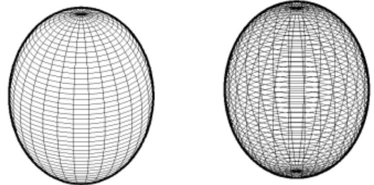
GERAÇÃO DO ELIPSÓIDE POR ROTAÇÃO DE UMA ELIPSE EM TORNO DE UM EIXO
