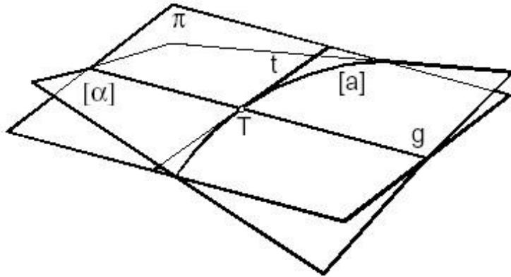
Numa superfície empenada simplesmente regrada  $[\alpha]$  o plano  $\pi$ , tangente a  $[\alpha]$  num ponto  $T$ , contém a geratriz recta  $g$  que por ele passa. Este plano intersecta a superfície segundo a recta  $g$  e segundo uma linha  $[a]$ . O plano  $\pi$  contém a recta  $t$  tangente à linha  $[a]$  no ponto  $T$ .
