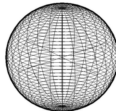
GERAÇÃO DA ESFERA POR ROTAÇÃO DE UMA CIRCUNFERÊNCIA EM TORNO DE UM DIÂMETRO
