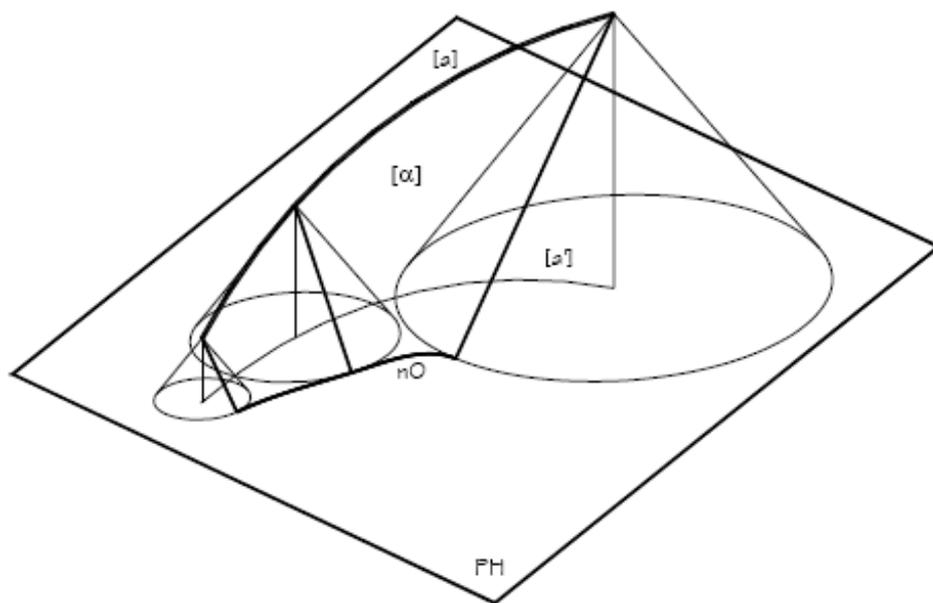
Uma superfície de igual pendente é sempre a superfície envolvente do movimento de uma superfície cónica cujo vértice se apoia na directriz [a].
