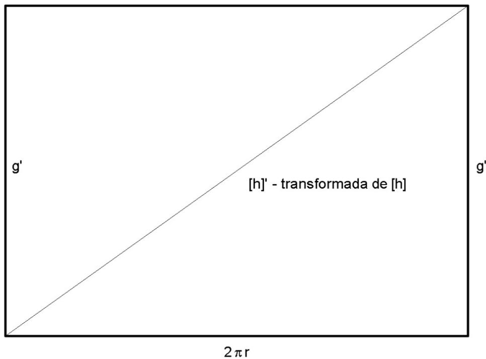
PLANIFICAÇÃO DA SUPERFÍCIE DO CILINDRO DE REVOLUÇÃO / HÉLICE CILÍNDRICA
