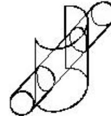
Da declaração feita, podem deduzir-se métodos gráficos para resolver a intersecção entre superfícies (e sólidos). Cada um desses métodos consistirá em definir superfícies auxiliares por meio das quais se determinam pontos das linhas de intersecção entre as superfícies base.
