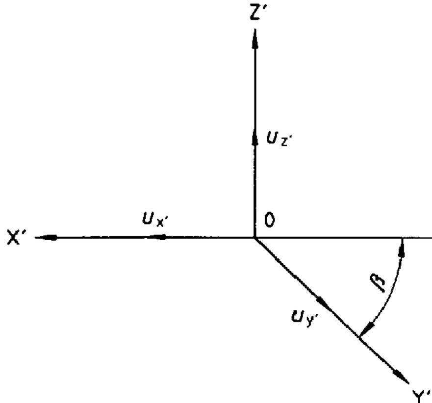
A axonometria de gabinete é em quase tudo igual à anterior. Na verdade é um tipo de axonometria cavaleira em que o coeficiente de redução em  $y$  (de acordo com a figura) é de 0.5.
