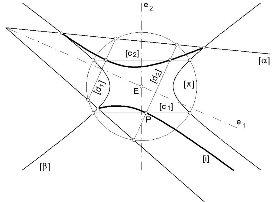
Para intersectar duas superfícies de revolução com eixos concorrentes, utilizam-se superfícies esféricas auxiliares
