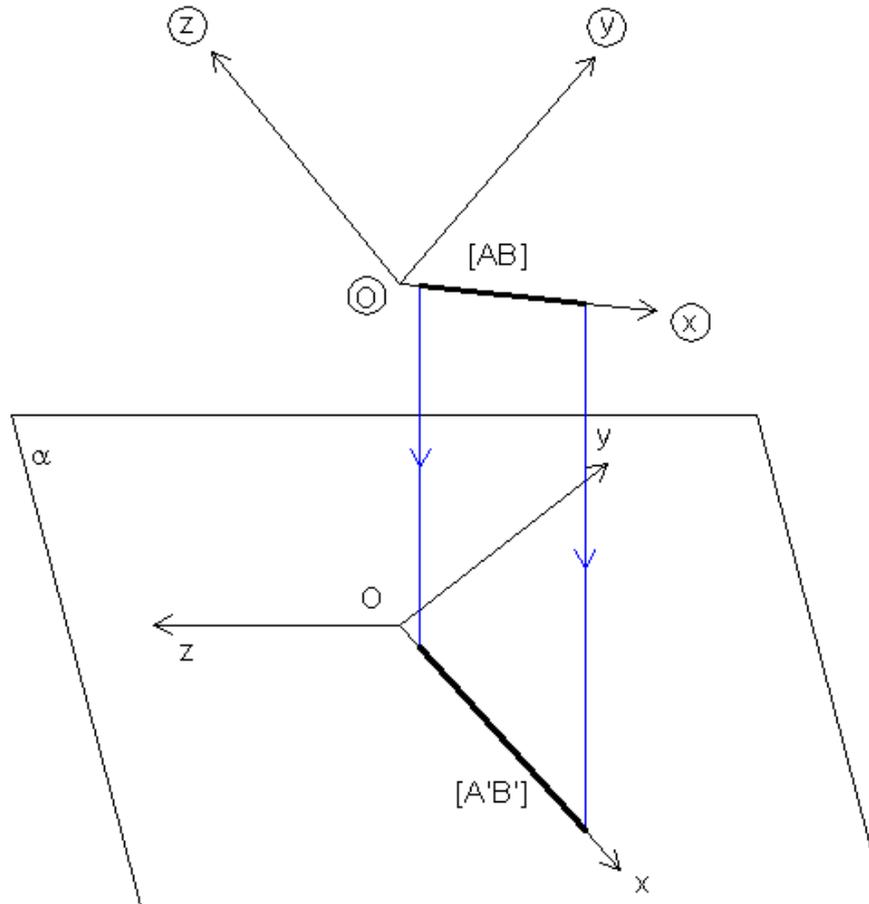
Assim, podemos estender o conceito de ESCALA ao conceito de ESCALA AXONOMÉTRICA. Esta corresponde à composição da escala do desenho com cada um dos coeficientes de redução. Assim, numa representação axonométrica há, em princípio, 3 escalas axonométricas distintas. Uma forma de impor as escalas axonométricas num desenho seria por exemplo a seguinte:
