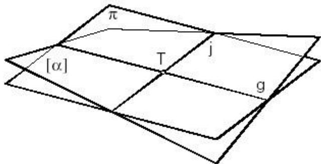
Numa superfície empenada duplamente regrada,  $[\alpha]$ , o plano  $\pi$ , tangente a  $[\alpha]$  num ponto  $T$ , fica definido pelas duas geratrizes rectas,  $g$  e  $j$ , que nele se intersectam. É o caso do parabolóide hiperbólico, do hiperbolóide escaleno e do hiperbolóide de revolução de uma folha.
