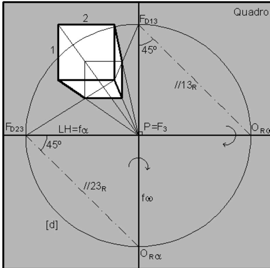
$F_{D23}$  PONTO DE FUGA DE DIRECÇÃO DE NÍVEL A  $45^{\circ}$  (ABERTURA PARA A ESQUERDA) COM O QUADRO
