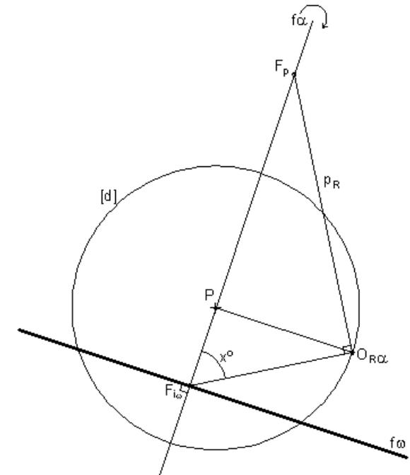
Graficamente, no caso geral, esta operação implica o rebatimento de um plano projectante  $\alpha$  em torno do seu traço no quadro,  $f_\alpha$ . Note-se que este plano contém a recta projectante  $p$  perpendicular ao plano projectante  $//\omega$ . Essa recta projectante  $p$  é perpendicular ao segmento  $[OF_{i\omega}]$ .
