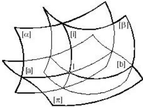
Se duas superfícies  $[\alpha]$  e  $[\beta]$  se intersectam segundo uma linha  $[i]$ , então existe pelo menos uma superfície  $[\pi]$  que intersecta a superfície  $[\alpha]$  segundo uma linha  $[a]$ , intersecta a superfície  $[\beta]$  segundo uma linha  $[b]$ , de tal modo que a linha  $[a]$  intersecta a linha  $[b]$  num ponto  $I$  da linha  $[i]$ .
