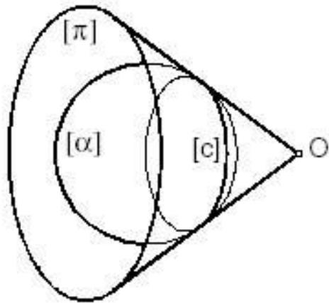
O contorno aparente de uma superfície  $[\alpha]$  para um “observador” (centro de projecções)  $O$  é a linha  $[c]$  de concordância entre a superfície  $[\alpha]$  e uma superfície cônica  $[\pi]$  de vértice  $O$ , que projectada a partir de  $O$  sobre uma superfície  $[\beta]$  qualquer determina nesta uma linha  $[c']$  que delimita a projecção de  $[\alpha]$ .
