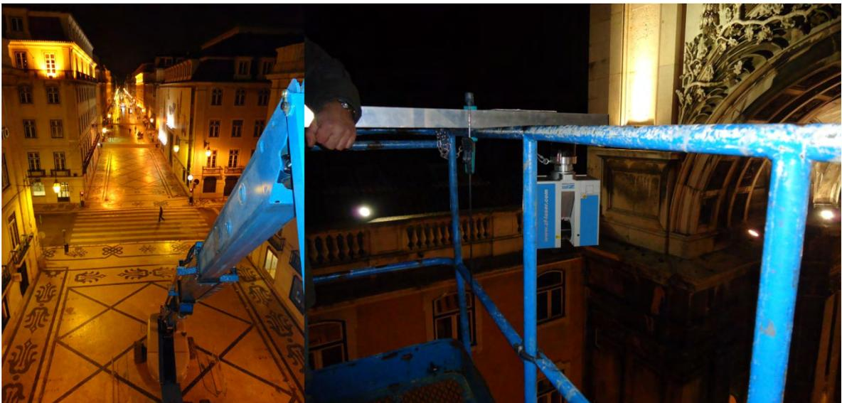
Figura 10-27: À esquerda: vista da Rua Augusta a partir da plataforma elevatória. À direita: solução de fixação do scanner de VL3D, em posição invertida, ao cesto da plataforma elevatória.
