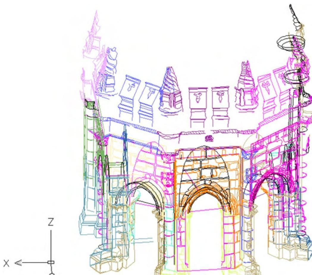
Figura 5-14: Modelo de linhas em ficheiro CAD resultante da assemblagem das várias restituições fotogramétricas parciais. As cores diferenciam os vários modelos produzidos.
