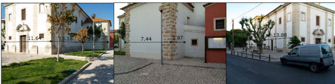
Figura 2-5: Medições directas registadas para controlo do processo de determinação do perímetro da igreja.
