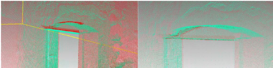
Figura 8-23: Erro verificado na orientação relativa (à esquerda) e a situação corrigida após nova orientação relativa (à direita).
