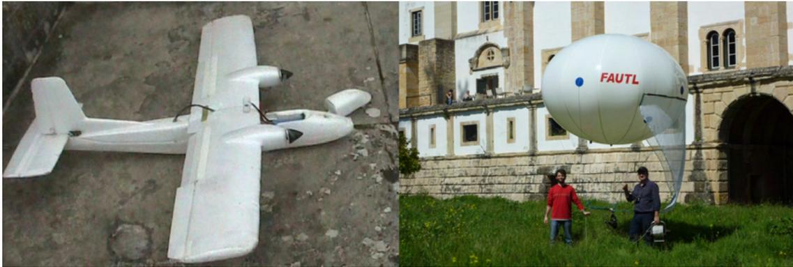
Figura 9-50:Imagens dos VANT de baixa altitude utilizados. À direita: balão a hélio equipado com câmara fotográfica e emissor vídeo (propriedade FAUTL). À esquerda: avião teleguiado equipado com câmara fotográfica (propriedade Aeroperspectiva).
