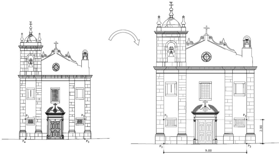
Figura 2-17: Correção final do desenho tendo em conta as medições directas de controlo feitas em campo.
