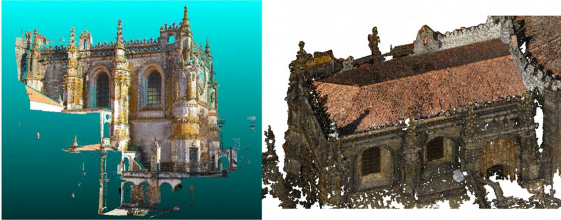
Figura 9-51: À esquerda: modelo de nuvens de pontos de VL3DT. À direita: modelo de nuvens de pontos fotogramétrico (12269339 pontos).
