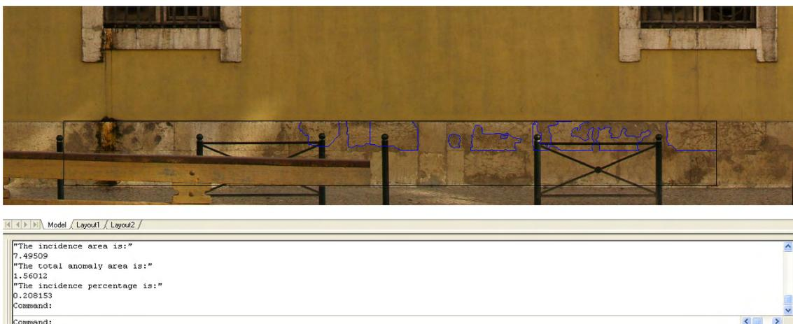
Figura 4-28: Aplicação das rotinas para cálculo de percentagens de incidência de anomalias.
