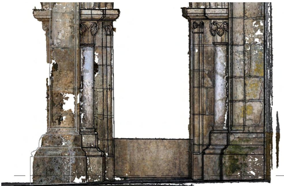
Figura 5-31: Comparação entre restituição gráfica 2D e orto-imagem.
