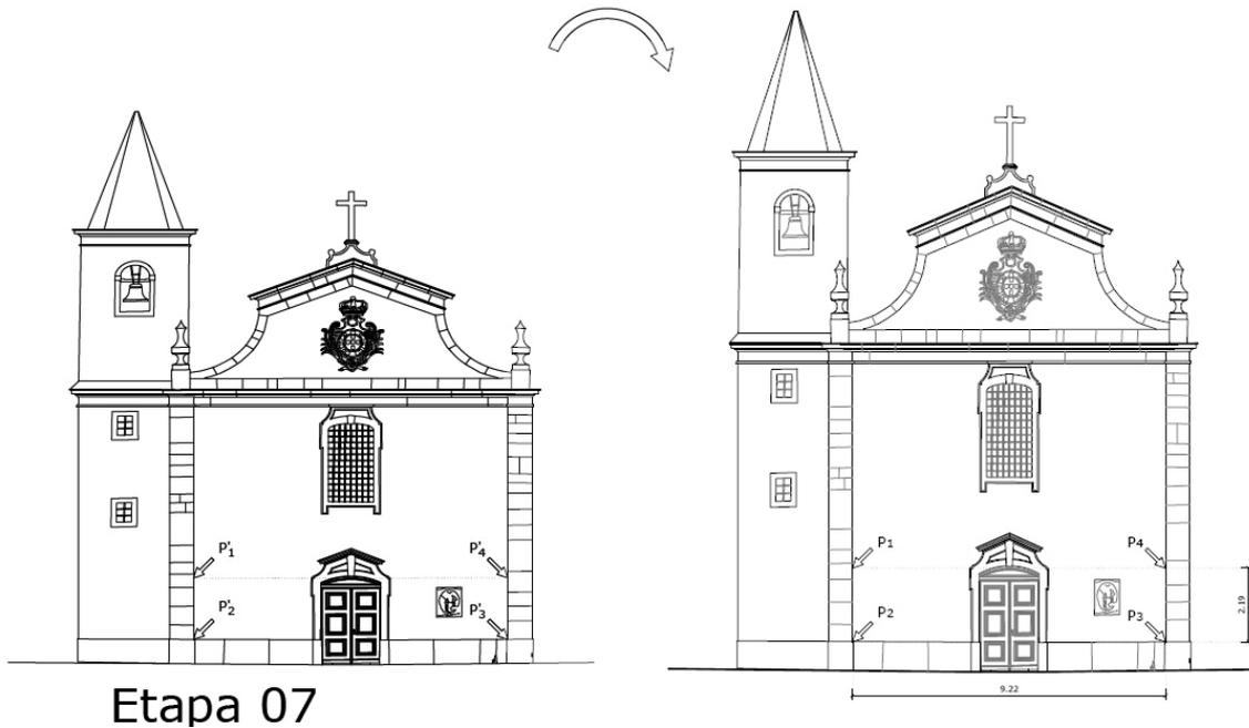
Figura 1-10: Correção final das dimensões do desenho recorrendo às medições directas efectuadas em campo.
