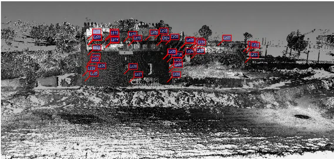
Figura 7-19: Modelo de nuvens de pontos com a identificação dos alvos.
