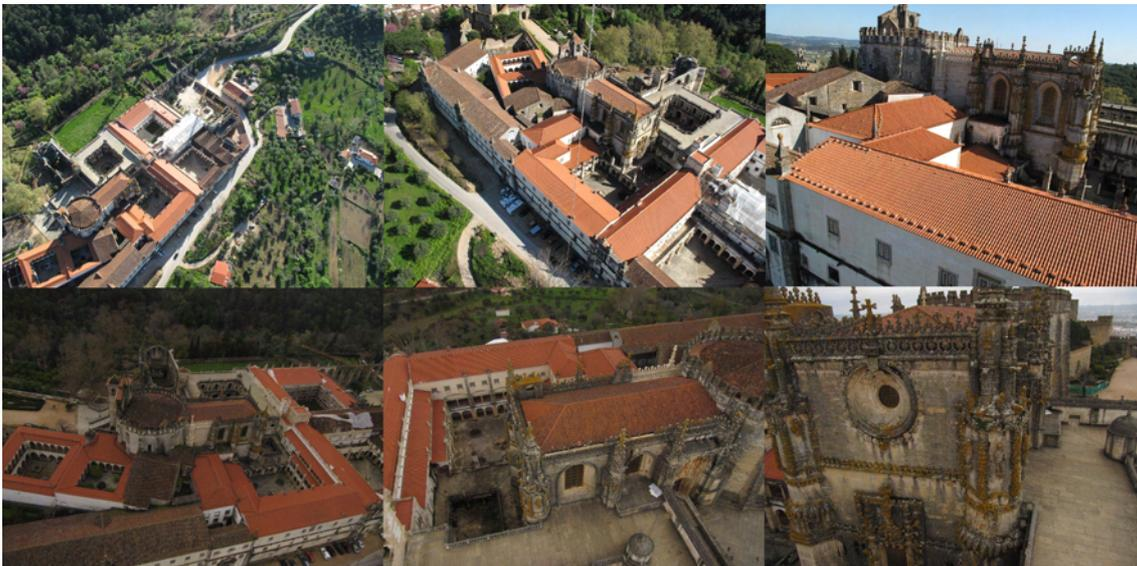
Figura 9-49: Exemplos de imagens aéreas do Convento de Cristo capturadas com balão (em cima) e com avião teleguiado (em baixo).
