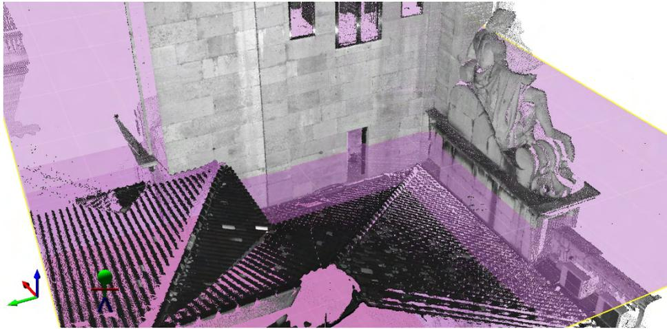
Figura 10-41: Visualização do plano de corte da planta 03.
