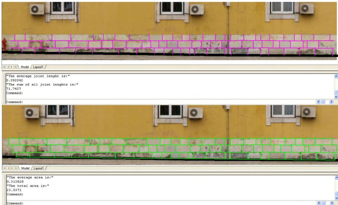
Figura 4-27: Aplicação das rotinas para cálculo de áreas e comprimentos médios.
