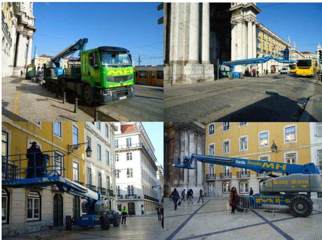
Figura 10-25: Sequência das operações de descarga e estacionamento da plataforma.
