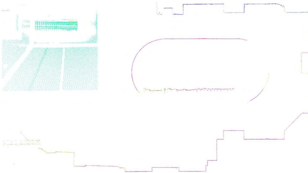
Figura 10-42: Fragmento de uma imagem da secção de relativa a um corte horizontal no modelo de nuvens de pontos.
