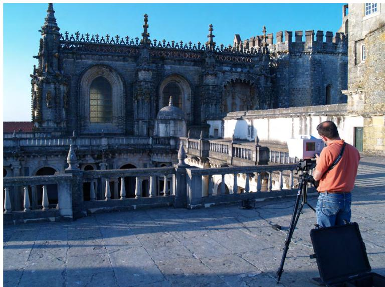
Figura 9-5: O scanner Optech Illris 3D sob operação.
