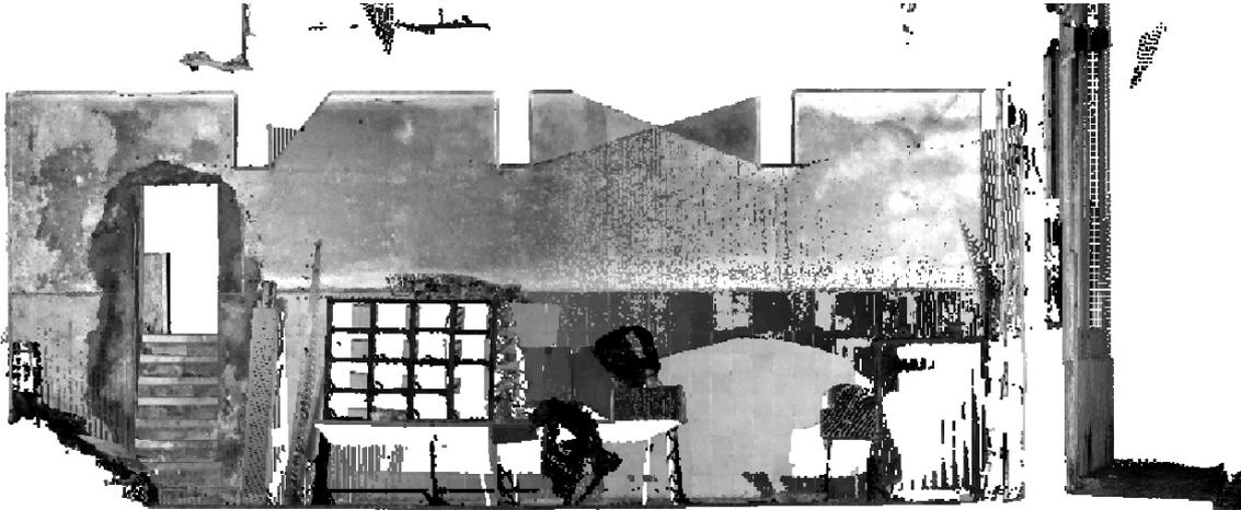
Figura 6-8: Efeito das oclusões nas imagens de reflectância e a procura de minimização através da utilização de nuvens de pontos com pontos de vista complementares.
