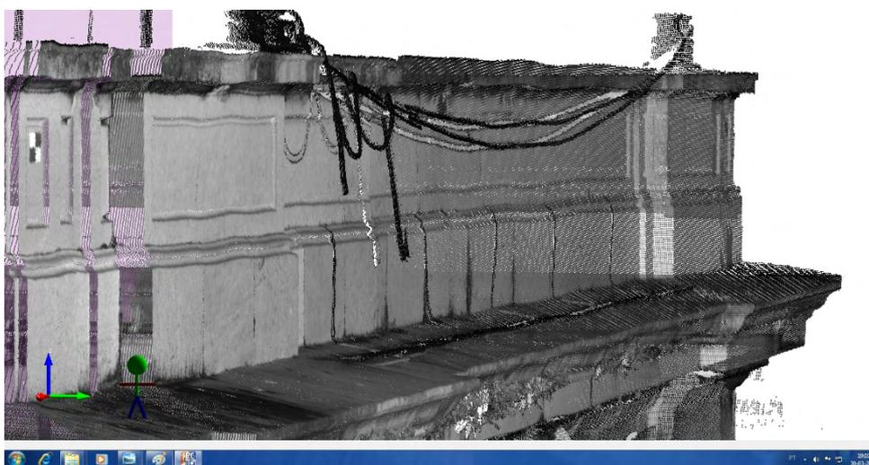
Figura 10-35: Nuvem de pontos com aspecto ondulado resultante do movimento da plataforma motivado pelo vento.
