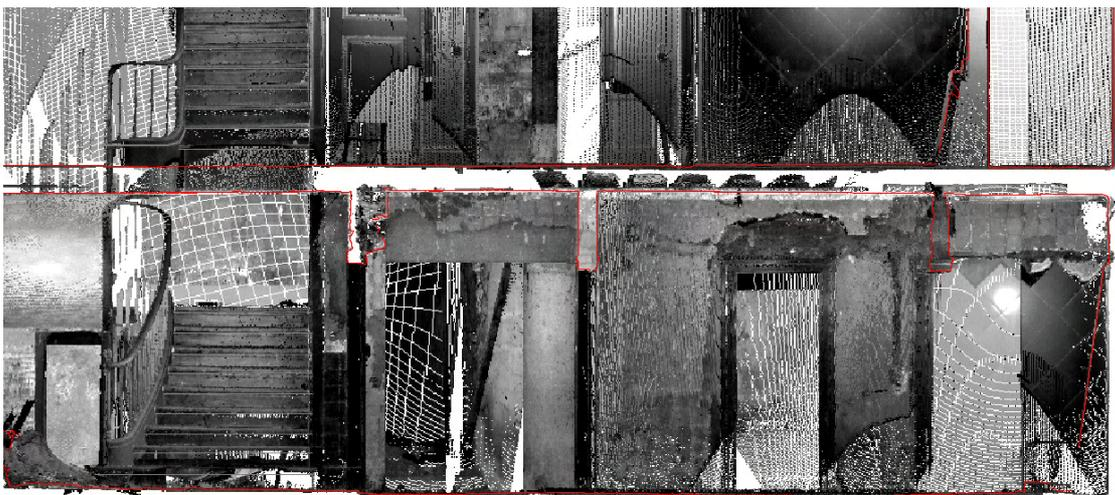
Figura 6-6: Configurações geométricas da imagem de reflectância resultantes do padrão de varrimento laser e do efeito de sobreposição de várias nuvens de pontos.
