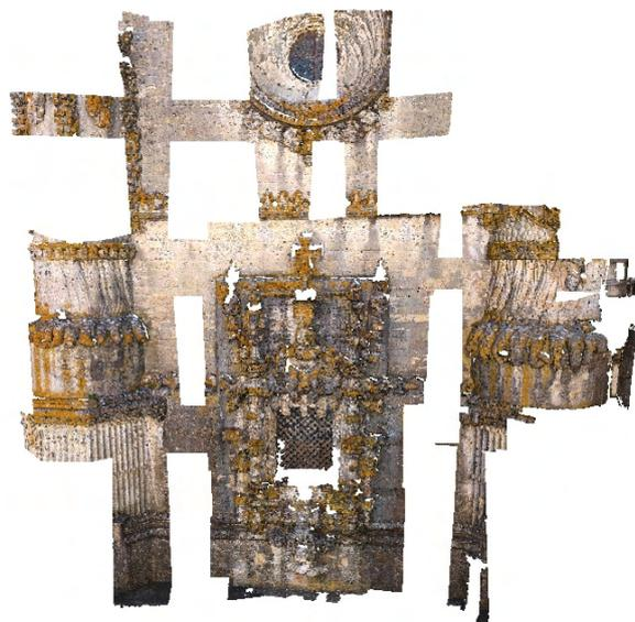
Figura 9-44: Imagem do modelo de elevada densidade, visualizado dom o software MeshLab, com um total de 6238451 pontos.
