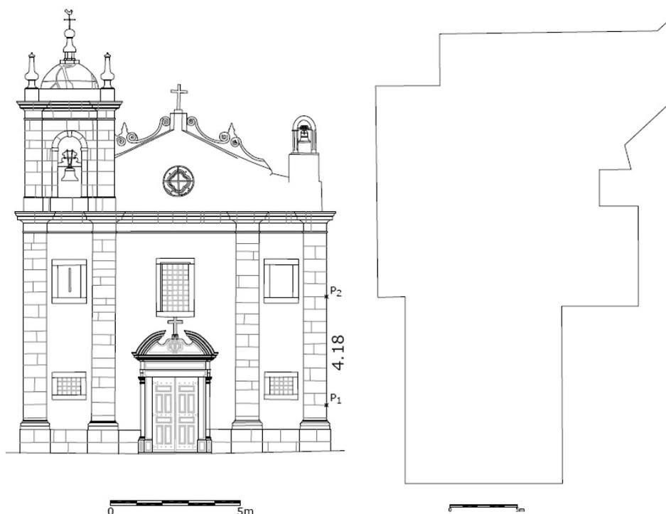
Figura 2-6: À esquerda: Medida de controlo vertical. À direita: desenho de controlo do perímetro da igreja obtido através de seccionamento de modelo de nuvem de pontos de VL3D.
