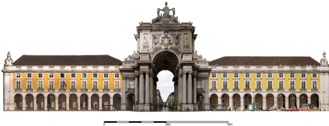
Figura 4-21: Alçado métrico rectificado da fachada sul do Terreiro do Paço.
