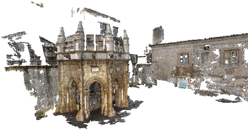
Figura 5-29: Reconstrução densa (CMVS+PMVS).
