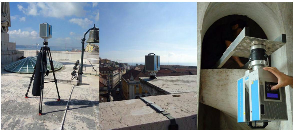
Figura 10-21: Scanner colocado sobre tripé (à esquerda), Scanner colocado directamente sobre superfície plana rígida (ao centro), Scanner colocado em posição invertida em dispositivo próprio (à direita).
