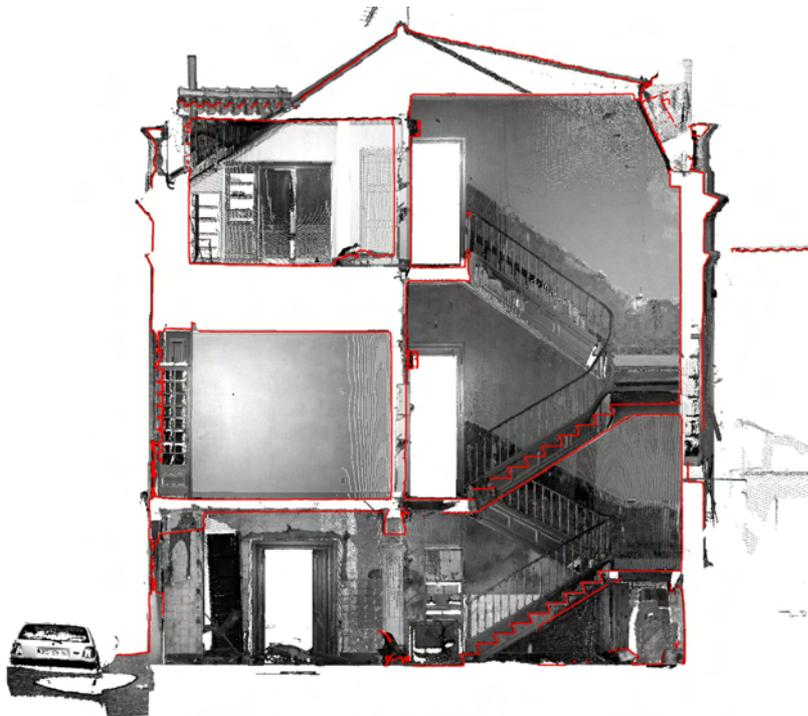
Figura 6-5: Imagem de reflectância de varrimento laser 3D correspondente à vista a partir de um corte.
