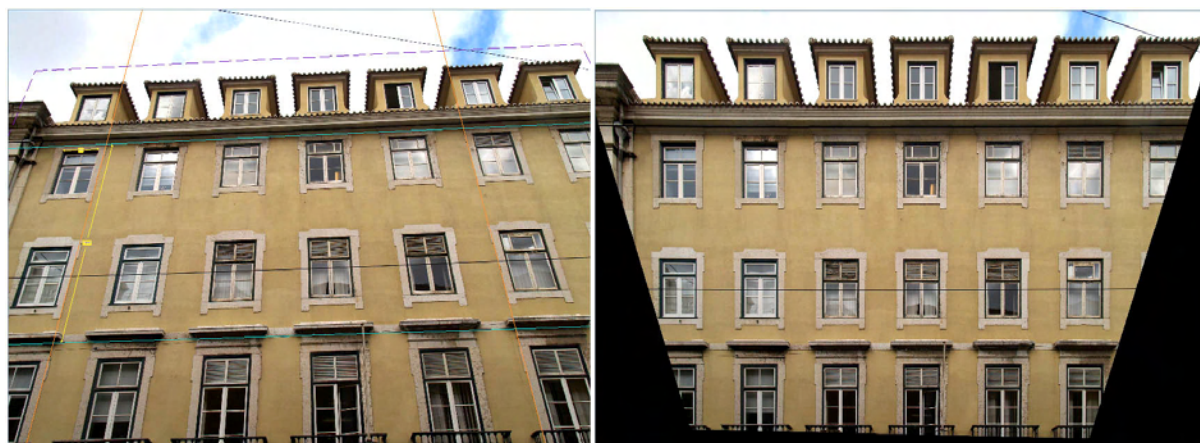
Figura 3-42: Imagem original (à esquerda) e imagem rectificada (à direita).
