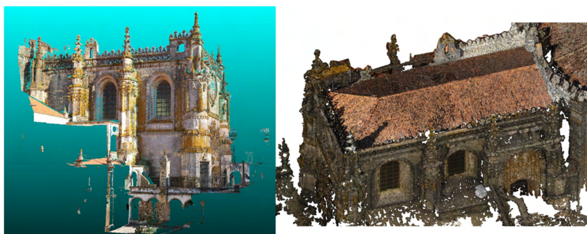
Figura 5-8: À esquerda: modelo de nuvens de pontos de VL3DT. À direita: modelo de nuvens de pontos fotogramétrico.
