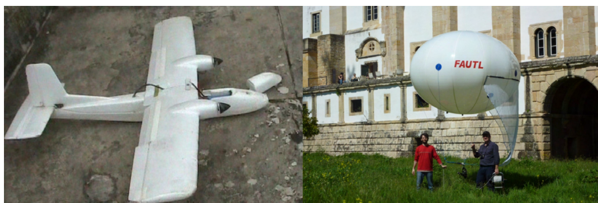
Figura 5-6: Imagens dos veículos aéreos de baixa altitude utilizados. À direita: balão a hélio equipado com câmara fotográfica e emissor vídeo (propriedade FAUTL). À esquerda: avião teleguiado equipado com câmara fotográfica (propriedade Aeroperspectiva).
