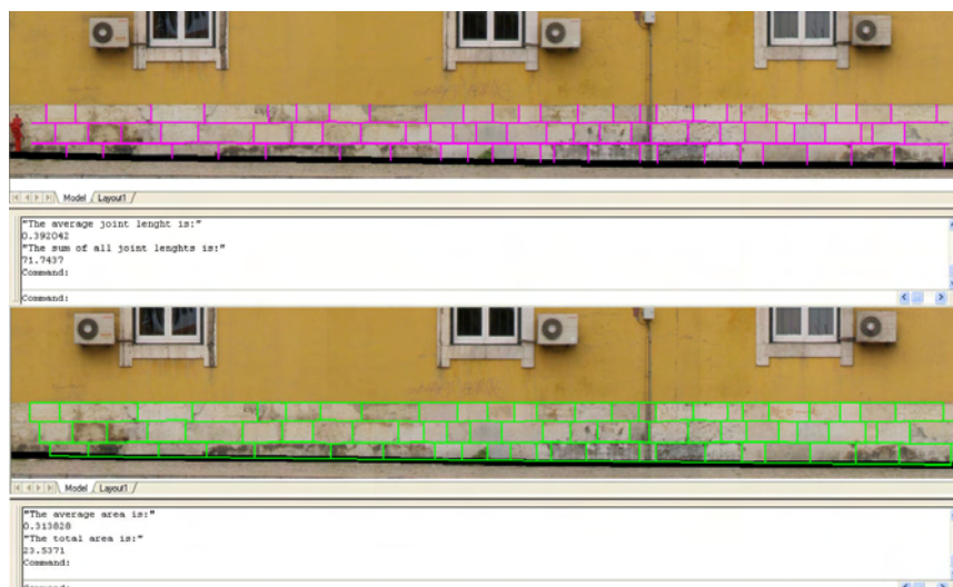
Figura 5-31: Aplicação das rotinas para cálculo de áreas e comprimentos médios
