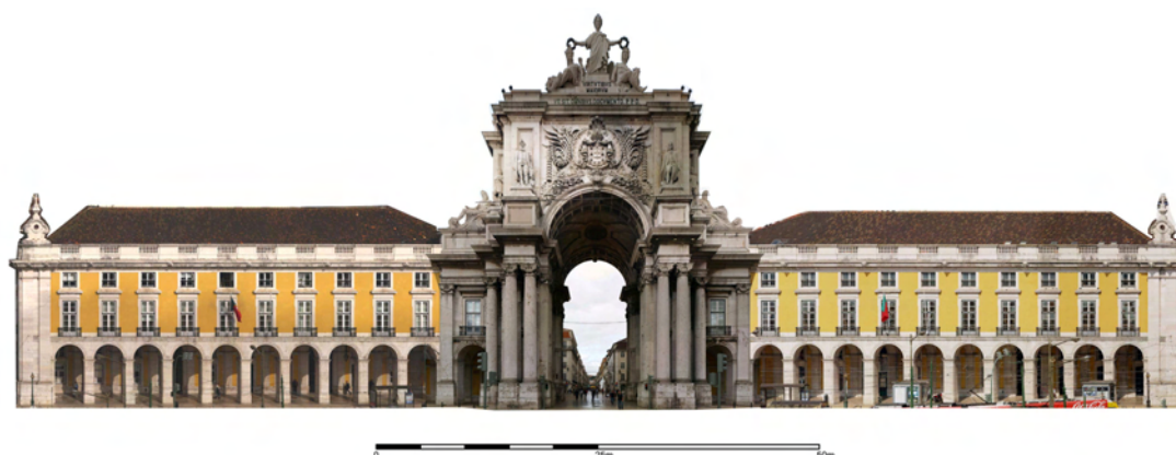
Figura 5-14: Alameda métrica rectificada da fachada sul do Terreiro do Paço.
