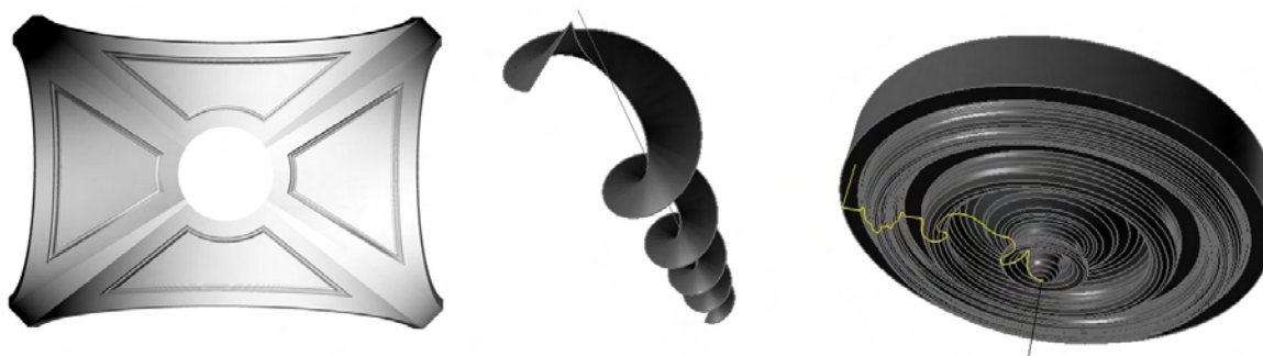
Figura 5-29: Modelação da abóbada (è esquerda), de intradorso de escadas (ao centro), de medalhão (à direita) como suporte do processo de medições.
