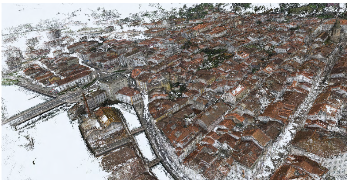
Figura 5-10: Modelo tridimensional do centro histórico da cidade de Tomar produzido a partir de 1154 imagens recolhidas a partir de balão a hélio controlado remotamente. Este modelo foi produzido pelo colega Victor Ferreira no âmbito do projecto FCT:PTDC/AUR/66476/2006, de que o autor da presente tese fez parte.
