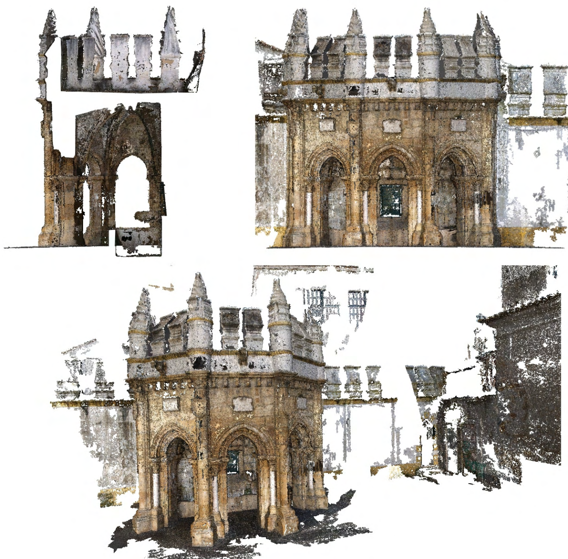
Figura 5-20: Imagens do modelo tridimensional de nuvens de pontos do Chafariz dos Canos extraídas através do processo de captura de ecrã.
