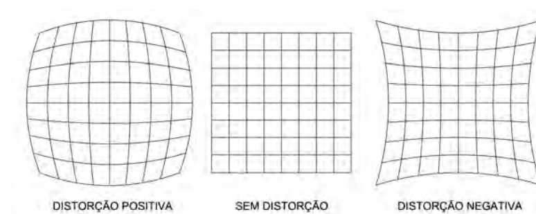
Figura 3-11: Tipos de distorção radial de uma imagem fotográfica.
