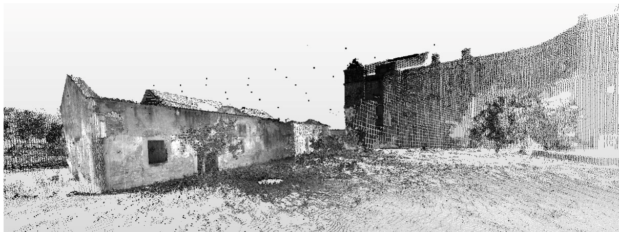
Figura 3-38: Nuvem de pontos com mapeamento de reflectância.
