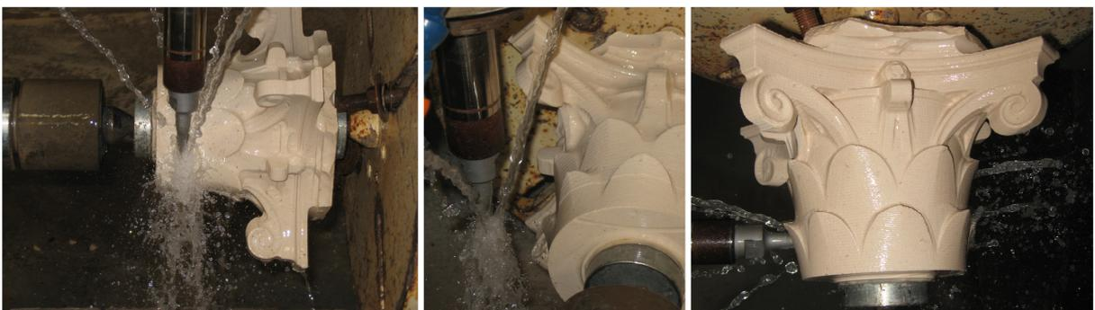
Figura 91 - Acabamento final com fresa widia de 3mm.
