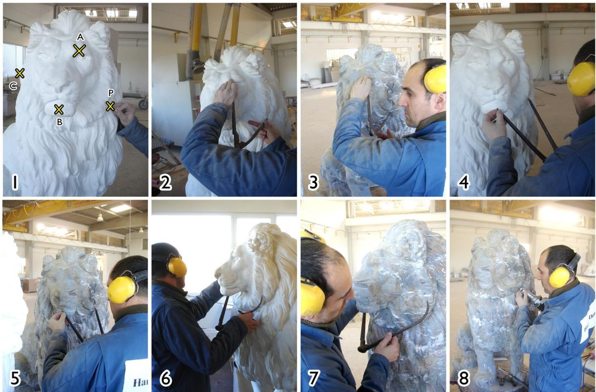
Figura 83 - Procedimento de cópia por compasso.
