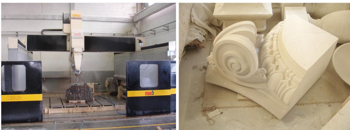
Figura 2 - Equipamento de fresagem automática de pedra. Capitel jónico de canto produzido por fresagem automática.
