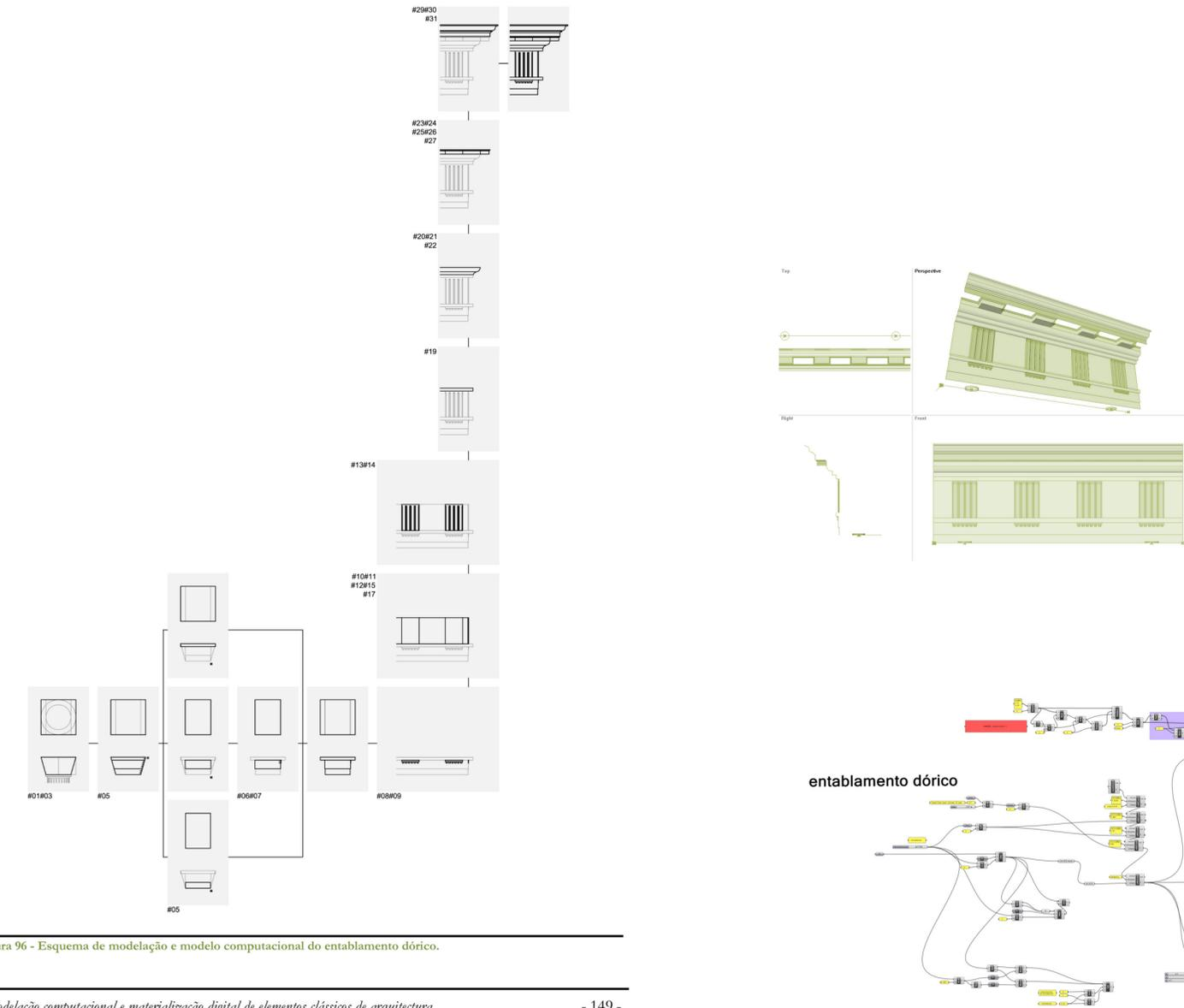
Figura 96 - Esquema de modelação e modelo computacional do entablamento dórico.
