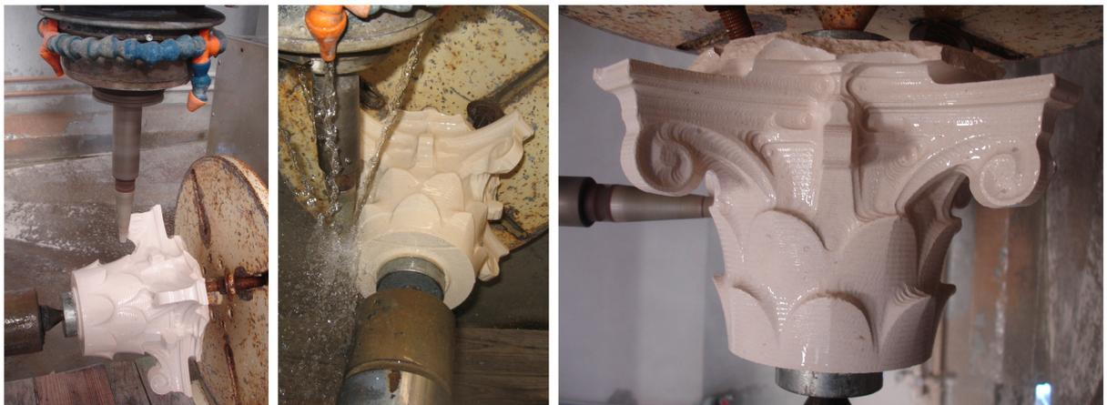
Figura 90 - Acabamento com fresa de 11 mm.
