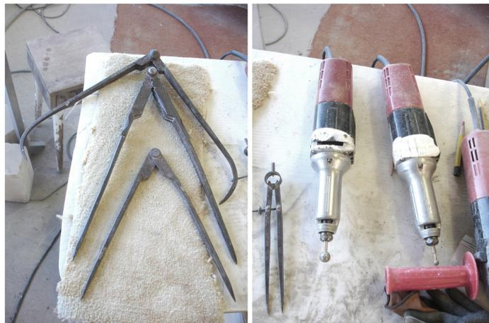
Figura 81 - Ferramentas necessárias à cópia por compasso.
