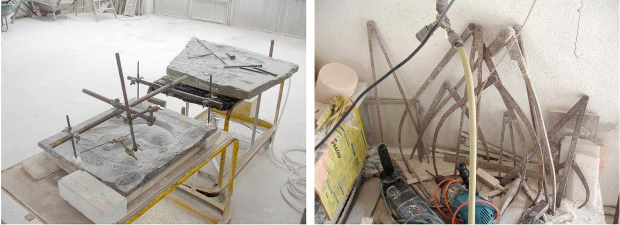
Figura 6 - Instrumentos de cópia em cantaria: a cruzeta e os compassos.
