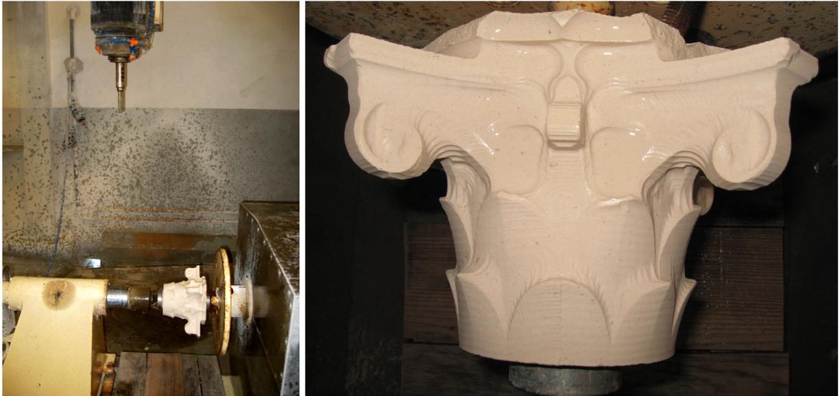
Figura 89 - Desbaste com fresa de 20mm.
