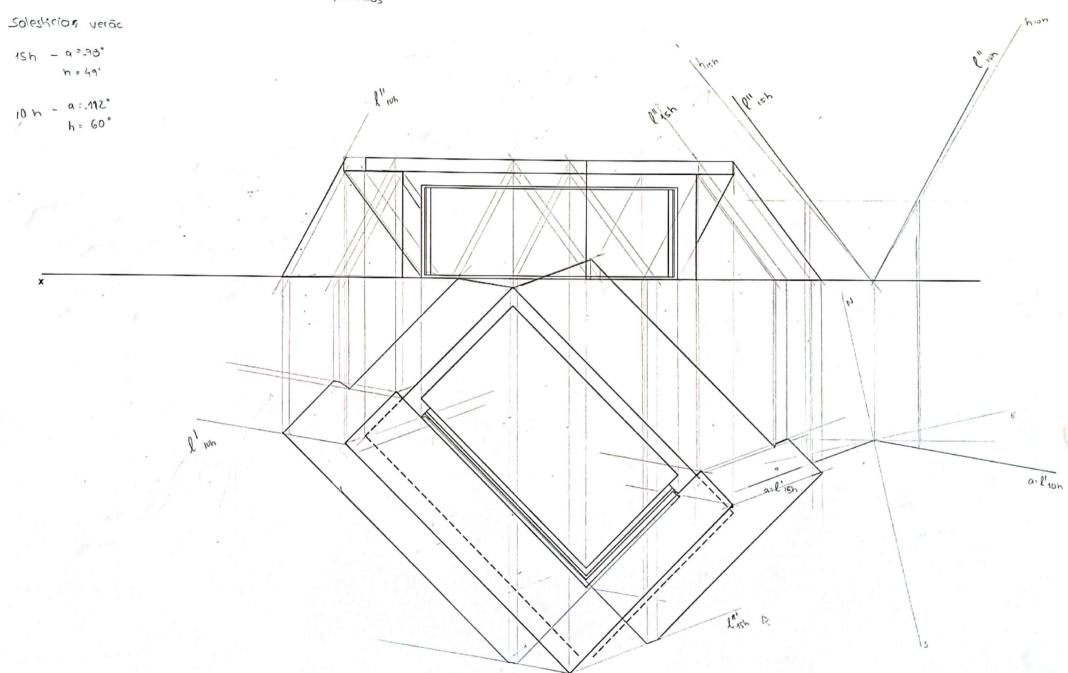
Dadas as projecções referentes a um objecto arquitectónico com uma grande fachada de vidro, apresentadas abaixo, e de acordo com a tabela de Insolarização para a cidade de Lisboa, determine a dimensão da pala a traço interrompido para que das 12 às 15 horas de Verão a iluminação solar não entre no interior do objecto mas que no mesmo horário de Inverno o possa fazer mais prolongadamente.
