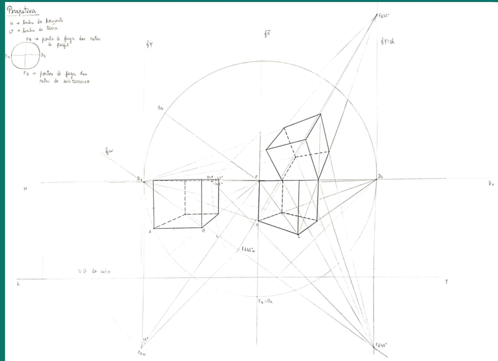
LT – Linha de Terra; P – Ponto de perspetiva do observador; D1 – Ponto de fuga do observador a 45°; D2 - Ponto de fuga do observador a 45°; Fs – Ponto de fuga das retas do subterrâneo; Or – Ponto do observador rebatido; Fd45° - Ponto de fuga de direção oblíqua a 45°
