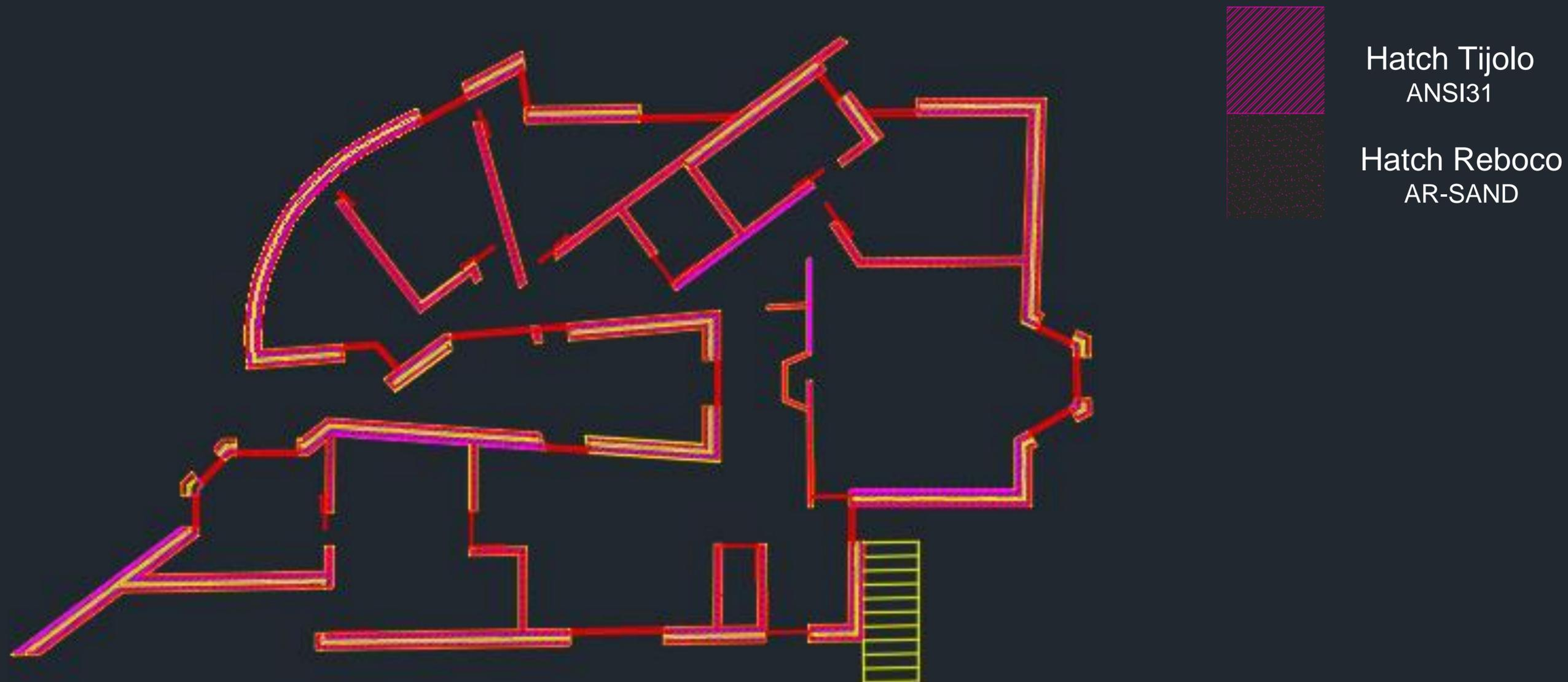
Colocação do Hatch do Reboco e do Tijolo, para isso foi preciso adaptar a escala do Hatch, porque por exemplo o Hatch do Reboco estava numa escala tão pequena que ficava completamente opaco, sem se notar os pontinhos, o Hatch do Reboco ficou na escala 0.1 e o do Tijolo ficou na escala 0.3
