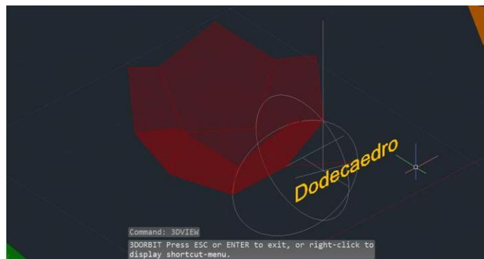
5. Fazer “**3DMIRROR**” e encaixar com o mirror com a base, através do “**ALIGN**”.
