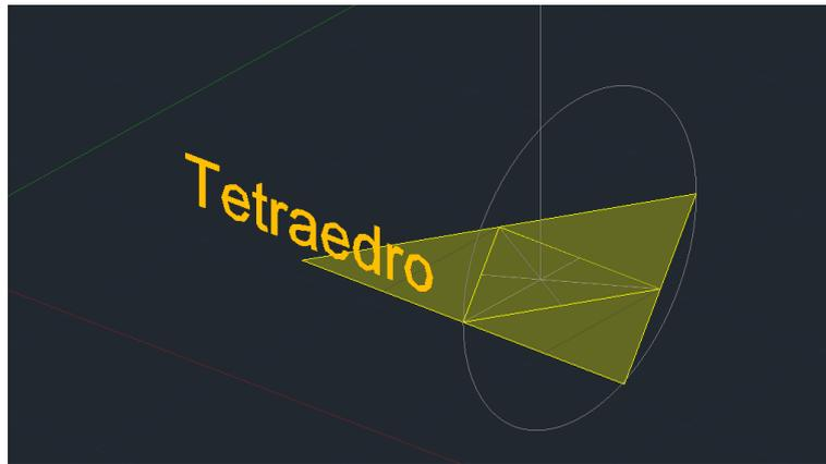
Fazer “3DROTATE” do triângulo de cima até ao ponto que une a linha ao círculo. (usar eixo vermelho). Fazer “ALIGN” do resto dos lados definindo 3 pontos.
