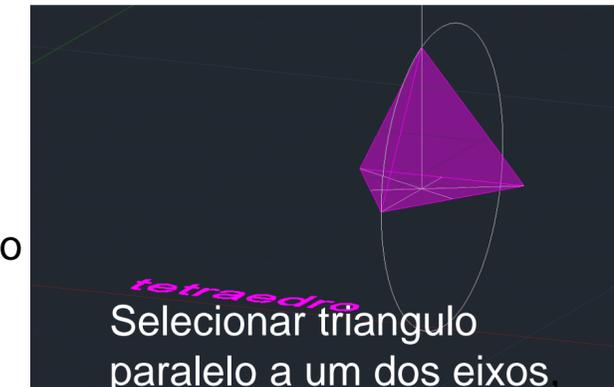
Selecionar triângulo paralelo a um dos eixos, usar comando 3DROTATE, mudar a bolinha com eixos para o meio da base do triângulo, selecionar o eixo que queremos usar selecionar vértice e rodar o triângulo.
