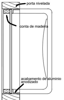
Detalhe do painel de vidro e do puxador. Escala 1/4
