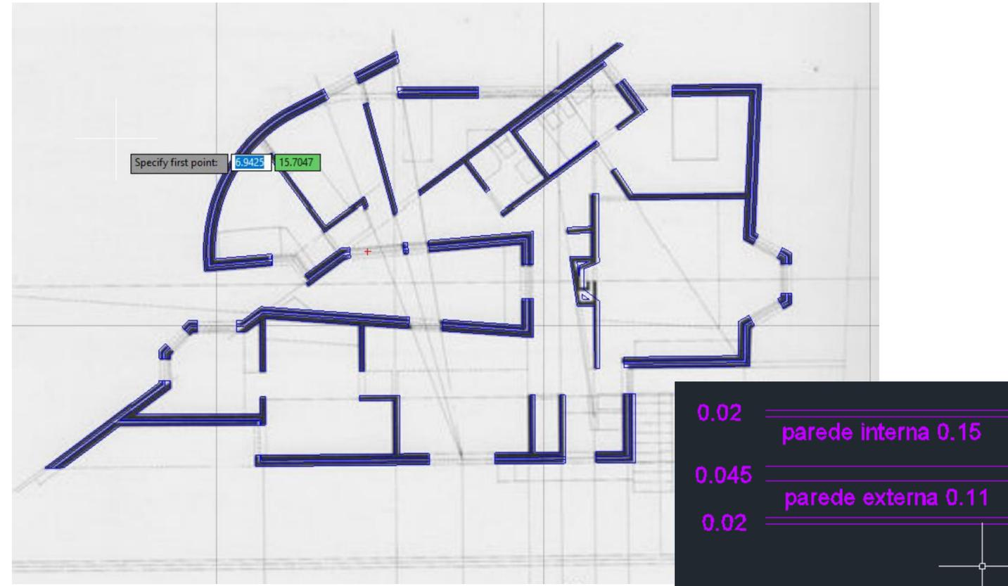
Coloca-se a imagem da planta através do comando ATTACH e desenho das paredes utilizando o comando LINE, ALIGN e OFFSET com uma distância de 0.345.
