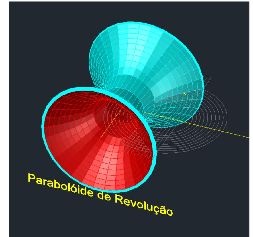
Através das circunferências e das retas chegamos aos pontos que vão originar a parábola, usamos POLYLINE para uní-los. Seleccionamos a polyline e com o comando REVSURF criamos uma parabólica de revolução (usando  $e$  como eixo de revolução) ou obtemos um parabolóide de revolução (se usarmos  $d$  como o eixo de revolução). Usando o commando SURFTAB1 e SURFTAB2 e colocando um valor de 30 ou 40 otemos uma superfície mais uniforme.
