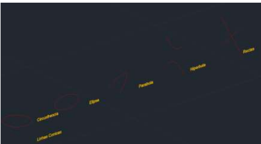
Linhas cónicas- somente as linhas exteriores (explodir as secções, o hatch ira desaparecer e apagar as linhas interiores)
