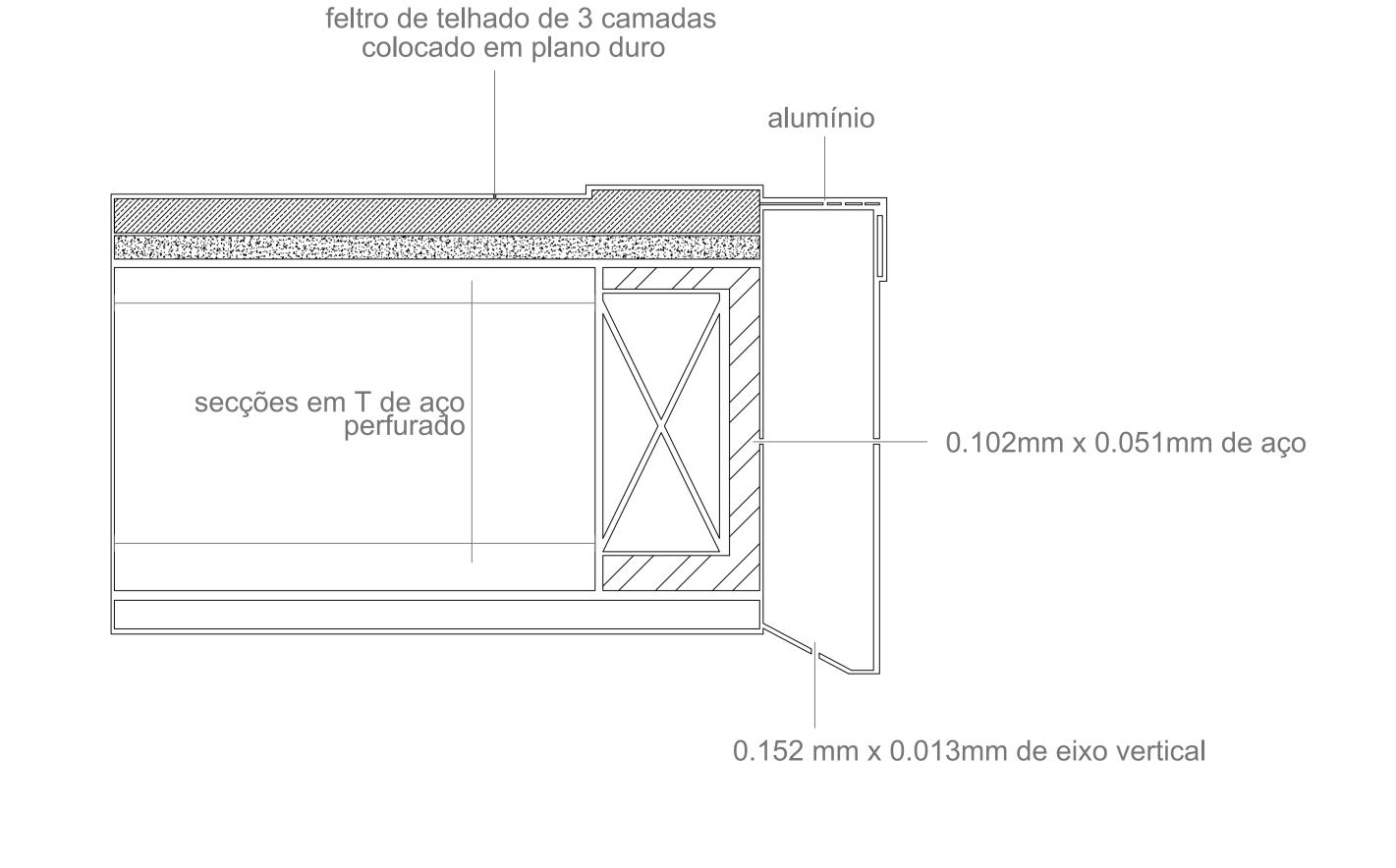
escala 1/50 DETALHE DO CORTE 'B'
