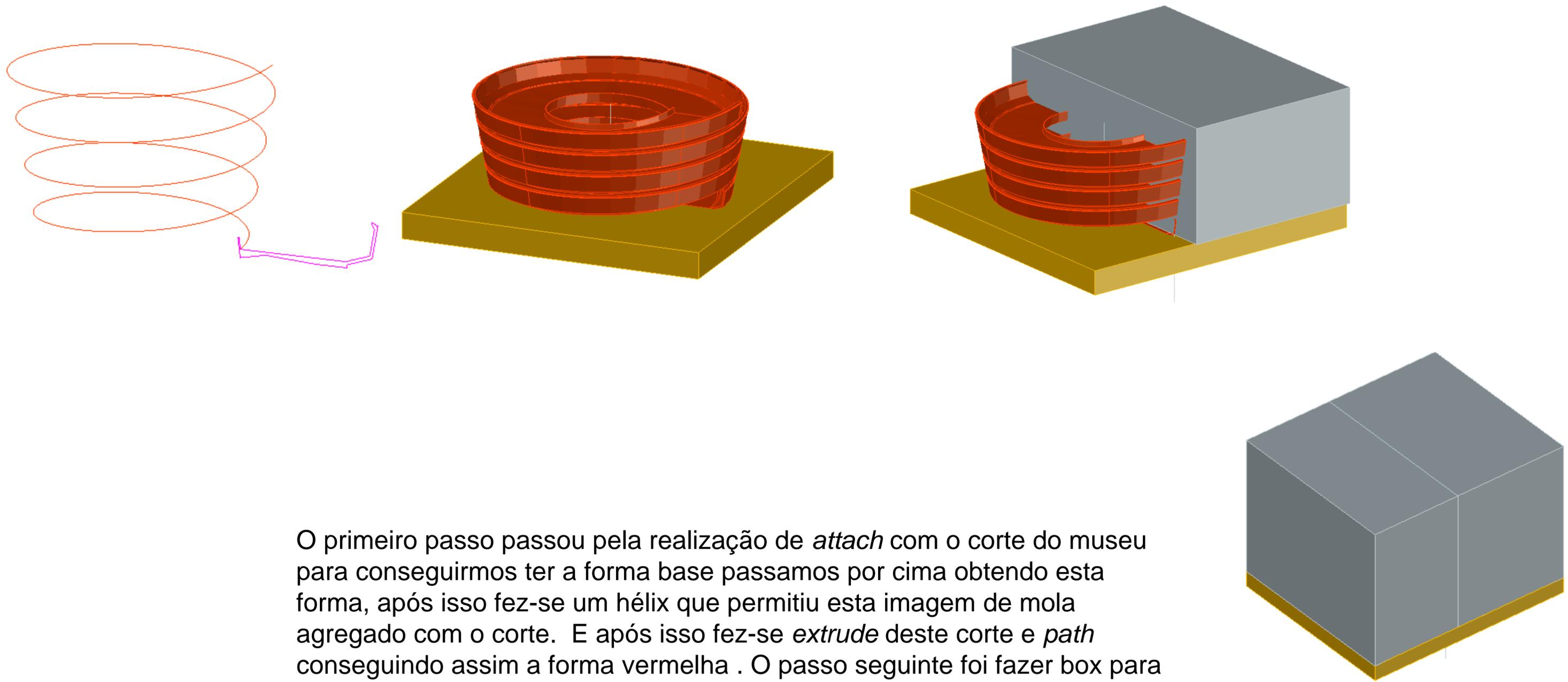
O primeiro passo passou pela realização de *attach* com o corte do museu para conseguirmos ter a forma base passamos por cima obtendo esta forma, após isso fez-se um hélix que permitiu esta imagem de mola agregado com o corte. E após isso fez-se *extrude* deste corte e *path* conseguindo assim a forma vermelha . O passo seguinte foi fazer box para a criação do terreno e fizemos outra box cinzenta a apanhar metade do modelo até ao limite do terreno repetiu-se este processo para o outro lado.
