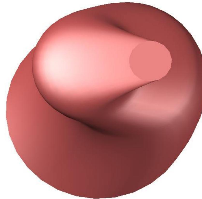
Para a realização do comando *loft* fez-se 4 círculos com tamanho diferentes em sítios diferentes mas perto uns dos outro após isso fez-se move para ficarem a alturas diferentes. Depois fez-se o uso do comando *loft* e clicou-se nos círculos numa única direção obtendo a forma final
