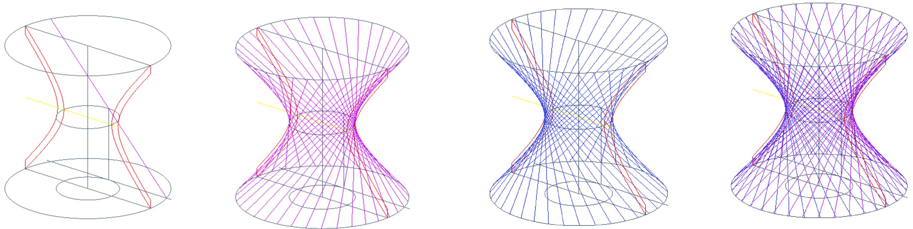
Após a realização do passo anterior fizemos a realização de um traço tangente a base de cima e de baixo passando pelo meio colidindo com o círculo mais pequeno. Com essa linha a rosa fez-se o comando `array> polar>axis rotation>itens>35` obtendo assim a segunda forma mais a esquerda, repetimos este processo mas com a reta para o sentido contrario criando assim a figura de azul. Realizando estas duas forma o ultima figura é a junção de ambos os processos
