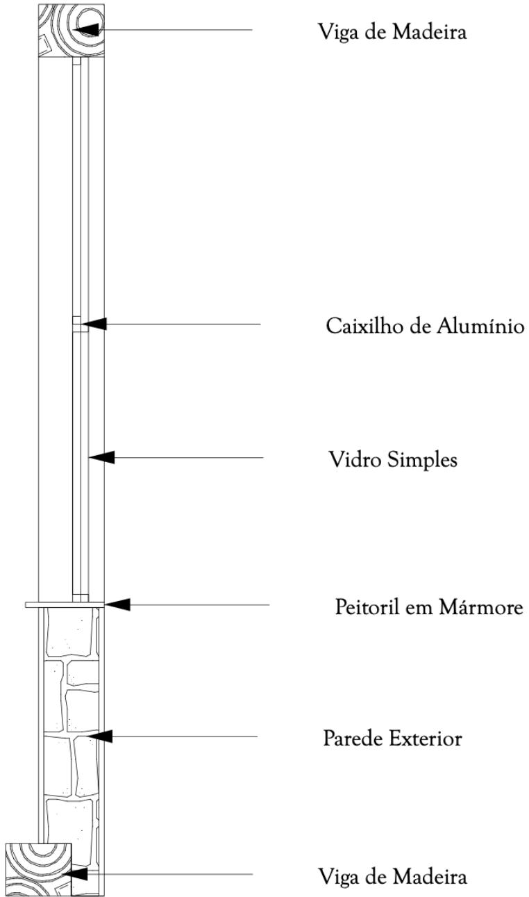
Encontro de pavimento com parede exterior
