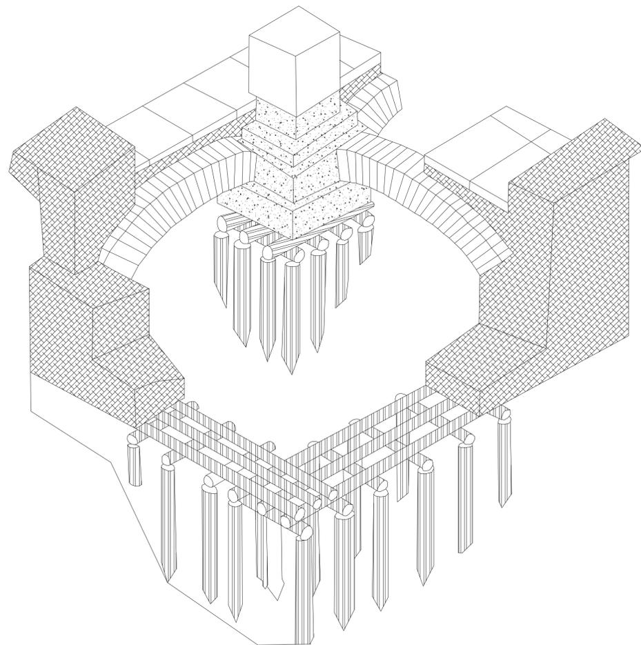
CORTE CONSTRUTIVO PERSPETIVADO FUNDAÇÕES ESCALA 1:20
